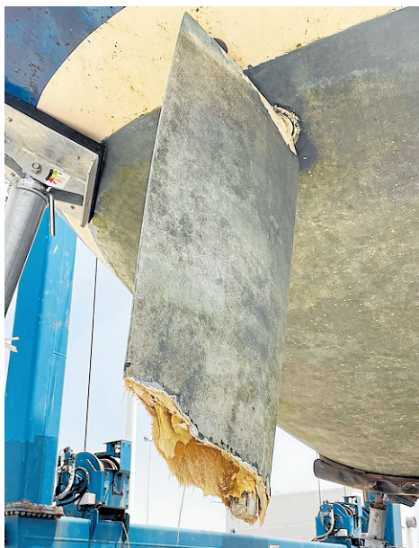
Von Orcas zerstörte Segelboote in der Werft von Barbate; Detailsicht eines zerstörten Ruderblattes. M. MEYER
